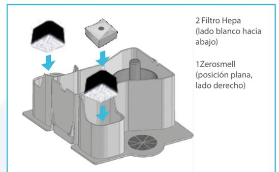
El mantenimiento básico consiste en el vaciado del depósito de agua y limpieza de los filtros de aire siguiendo las instrucciones del manual del usuario. Veltia Hand Dryer cuenta con un depósito electrónico que advierte al usuario la necesidad de mantenimiento por medio de señales luminosas y sonoras.
